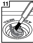
11 Unteren Kegel mit Bürstchen reinigen
