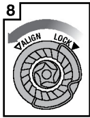
8 Oberen Kegel entriegeln
